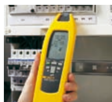
Определение местонахождения предохранителей/прерывателей и привязка к цепям
