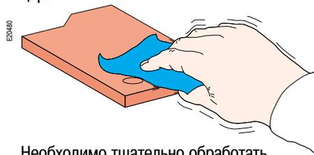
Необходимо тщательно обработать поверхности срезов и выбитых отверстий, а затем удалить образовавшиеся опилки. При необходимости обезжирьте шину, а затем слегка обработайте контактные поверхности с помощью мелкозернистой абразивной шкурки.
