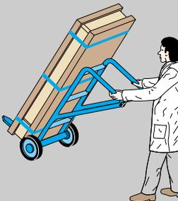
*Перевозить малые шкафы необходимо также на тележке для перевозки поддонов (в горизонтальном положении) или используя двухколесную тележку.*
