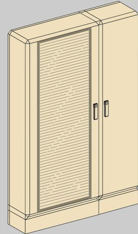
Степень защиты электрического щита, к которому имеет доступ неквалифицированный персонал, должна быть не менее IP2 или IPXXB (B – дополнительная буква, обозначающая защиту людей от доступа к частям под напряжением).
